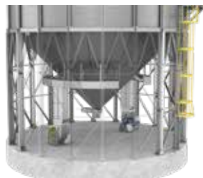
Aeração silo fundo cônico - vista externa
