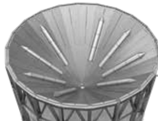
Aeração silo fundo cônico - Vista interna
